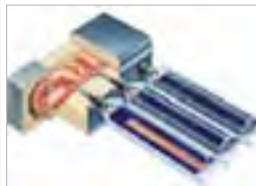
Τομή σωλήνα θερμότητας ξηρής σύνδεσης
